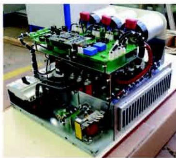
Рис.1 Система построения напряжения 6кВ в фазах ВПЧ из ячеек по 690В
