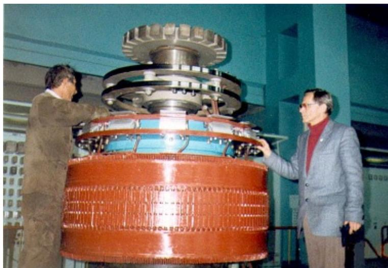
**Рис. 1.** Общий вид якоря бесщеточного возбудителя.
