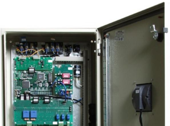
**Рис. 1.** Автоматический регулятор возбуждения AVR-8-BR-Q1D для синхронных двигателей.
